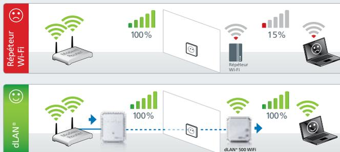
devolo utilise le réseau électrique 220V pour transférer le signal de la box vers dLAN® 500 WiFi sans obstacles. Ce réseau est stable et rapide. En effet, la bande passante de votre connexion ADSL est disponible à dans chaque prise de courant. Dans laquelle un adaptateur dLAN® 500 WiFi est branché. Tout à l'inverse d'un répéteur Wi-Fi qui ne fait que relayer un signal déjà affaibli ; avec comme résultat une très mauvaise qualité de réception!
